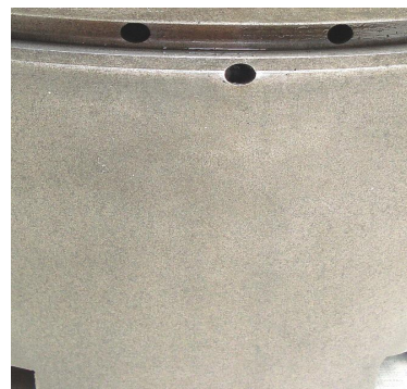
Рис.1. Боковая поверхность поршня К6S310DK преобразованная гальвано-плазменным методом [2]
